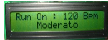
Hasil Tampilan LCD dengan Tempo 120 BPM
