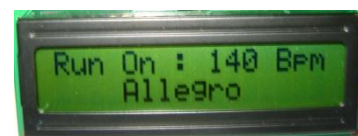
Hasil Tampilan LCD dengan Tempo 140 BPM
