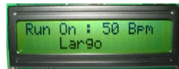
Hasil Tampilan LCD dengan Tempo 50 BPM
