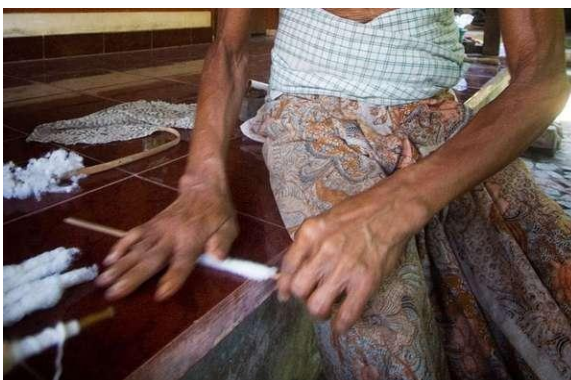
Gambar 2.16. Proses penggilasan kapas menggunakan tangan
