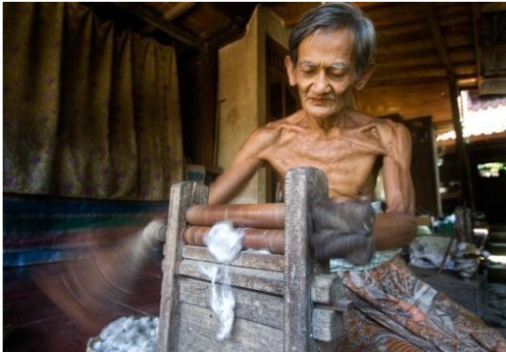
Gambar 2.15. Proses Penggilasan Kapas Menggunakan Alat Penggilas Kapas
