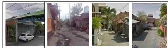
(1) Kondisi pintu masuk Perumahan Puri Taman dengan sistem onegateway lebar 3 meter (2) Jalan masuk Perumahan, jalan aspal dengan lebar 3 meter terdapat lampu jalan dan saluran got (3) Jalan transisi depan Perumahan, jalan aspal dengan lebar 3 meter terdapat saluran got (4) Jalan transisi depan Blok Perumahan, jalan aspal dengan lebar 3 meter terdapat saluran got
