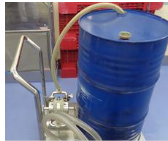
Gambar 4. Rancangan Rinci Alat Bantu Penimbangan Glycerin
