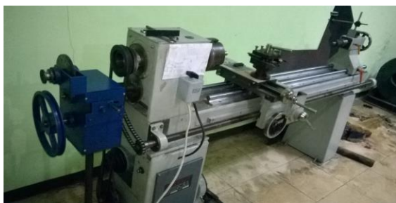
Gambar 6. Mesin Bubut Kayu Oskar MCF3020A dengan Penambahan Nonius dan Gearbox
