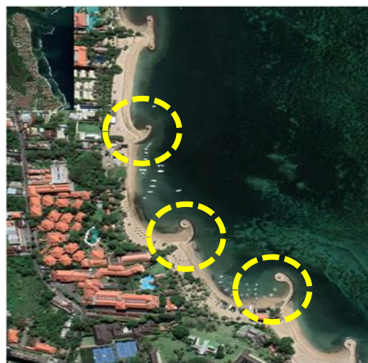
Gambar 8. Pembangunan groin (dinding penahan pasir) yang estetik membentuk ruang rekreasi dan arena jogging track
