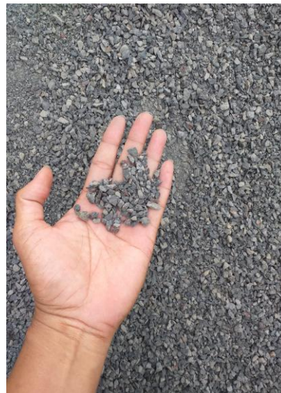
Gambar 4. Material Pengisi Lubang Resapan Biopori Sumber : ( Dharsika, 2022)
