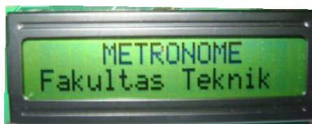
Hasil Pengujian Tampilan Karakter Pada LCD
