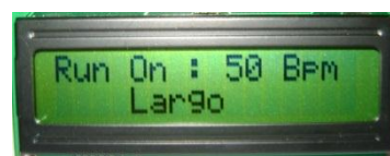
Hasil Tampilan LCD dengan Tempo 50 BPM
