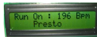
Hasil Tampilan LCD dengan Tempo 196 BPM
