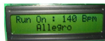
Hasil Tampilan LCD dengan Tempo 140 BPM
